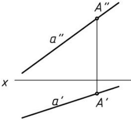
2. Построить проекции горизонтального отрезка  $AB$  перпендикулярного к прямой  $a$  с точкой  $B$  на прямой  $a$ . Определить длину отрезка  $AB$  и угол его наклона к фронтальной плоскости проекций.
