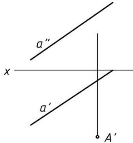
3. Определить угол наклона плоскости, заданной параллельными прямыми  $a$  и  $b$ , к фронтальной плоскости проекций.
